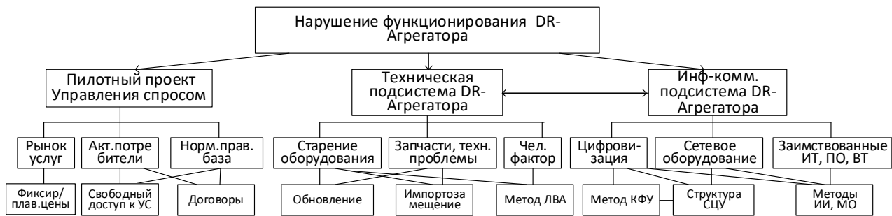
Рис. 2. Дерево угроз функционированию DR-Агрегатора
