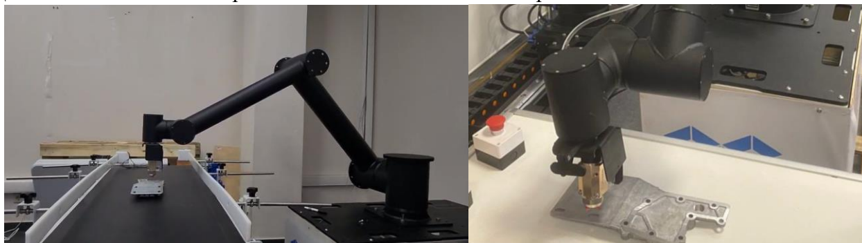
Рис. 6. Технологическая операция покраска детали
