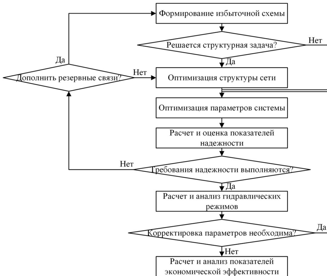
**Рис. 1.** Алгоритм решения задачи проектирования систем теплоснабжения
