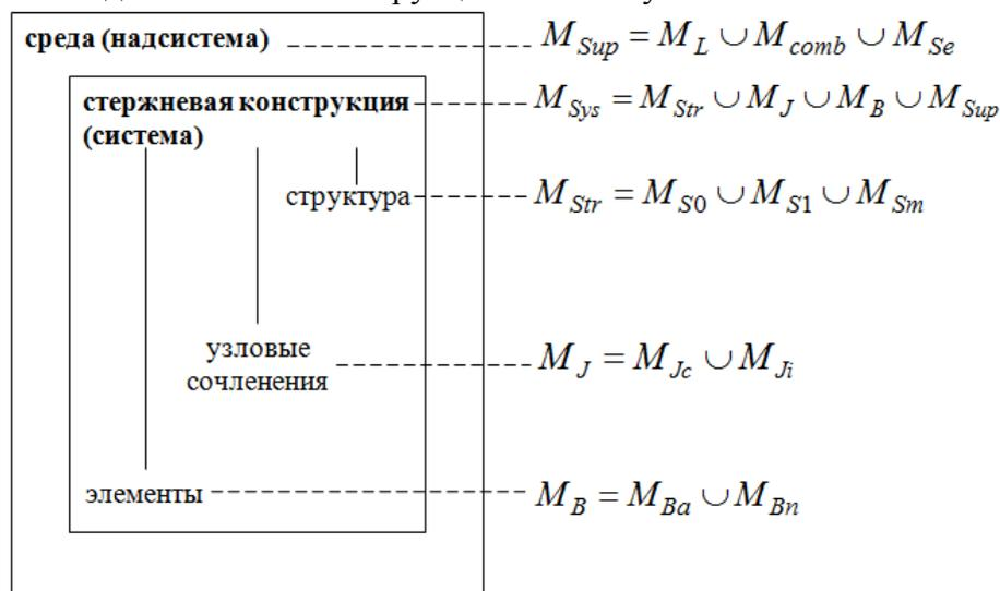
**Рис. 1.** Иерархия моделей анализа живучести стержневых конструкций:
