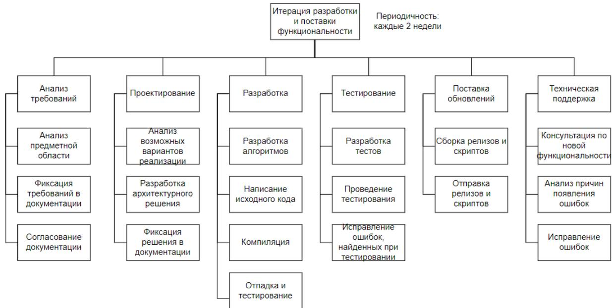
Рис. 3. Функциональная СДР одной итерации разработки ПО
