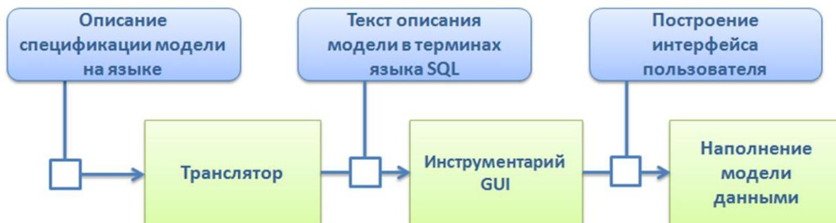
Рис. 2. Схема работы подсистемы спецификации модели
