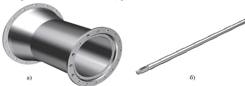
а – вал турбины высокого давления; б – шпилька призонная
